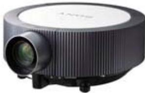
WXGA-Auflösung 1366x800px und 7000 Lumen, 2-Lampen Technik, Anorganische LCD-Panels für lange Lebensdauer, 30kg, SHIFT-Optik horizontal und vertikal, optionale Wechselobjektive
