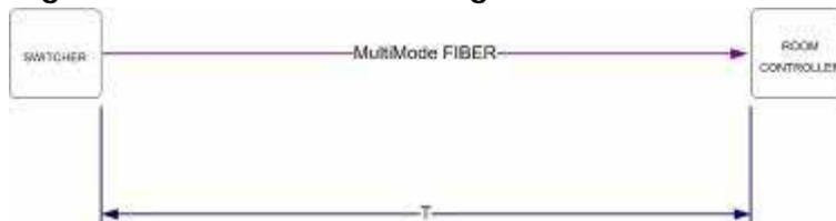
Übertragungsstrecke über Glasfaserkabel ist unabhängig von der Auflösung des Signals. Aus diesem Grund ist dort nur eine Zahl aufgeführt.
